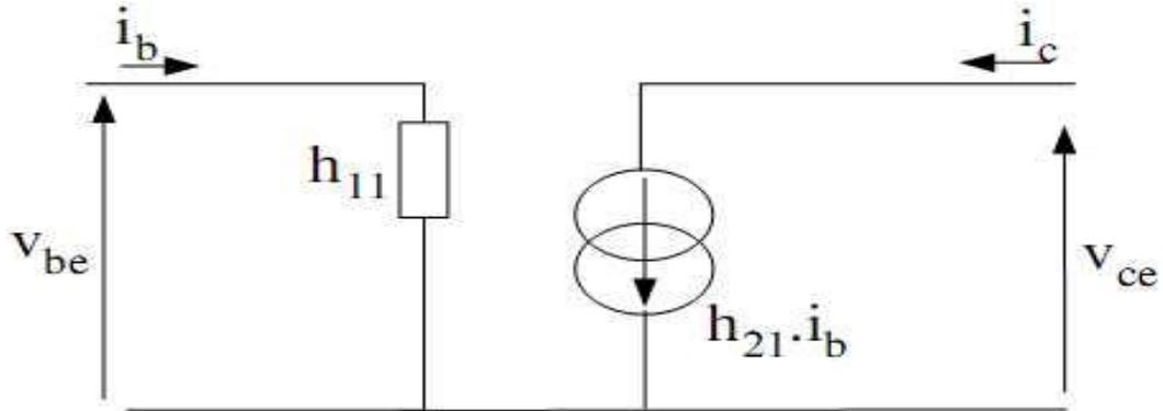
Donc  $i_c = h_{12}i_b$  et sachant que  $i_c = \beta i_b$ , on a donc  $h_{12} = \beta$ .
