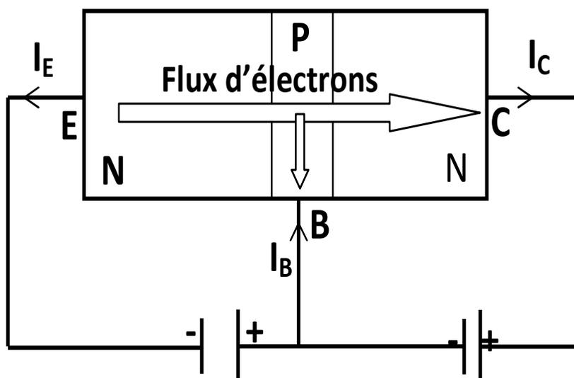
Soit un transistor NPN, sous l'action d'un champ produit par la tension  $V_{BE}$  (polarisation directe de la jonction B-E), les majoritaires de la région émetteur passent dans
