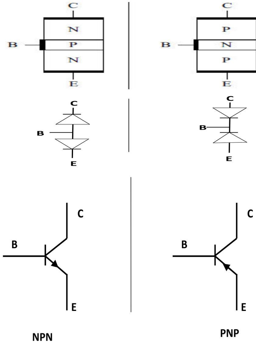
Les trois zones ainsi dopées forment deux jonctions : la jonction base-émetteur (BE) dite jonction de commande, et la jonction base-collecteur (BC).
